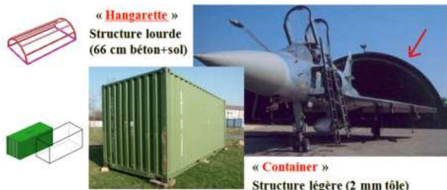
Fig. C6 : deux géométries-type traitées dans le projet RAIMANTA
